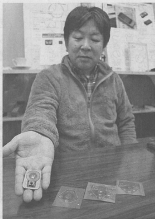
エリートが新潟工科大と共同開発した車いす用リモコン。改良を繰り返して小型化した。上越市
